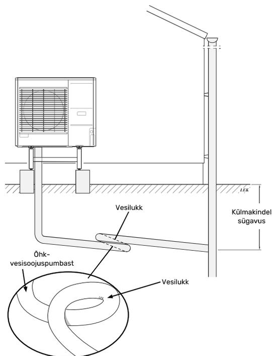
Suunake toru soojuspumba juurest allapoole. Kondensaatveetorul peab torus tekkiva õhuringluse vältimiseks olema vesilukk. Paigaldise pikkust võib reguleerida vesiluku suuruse võrra.
